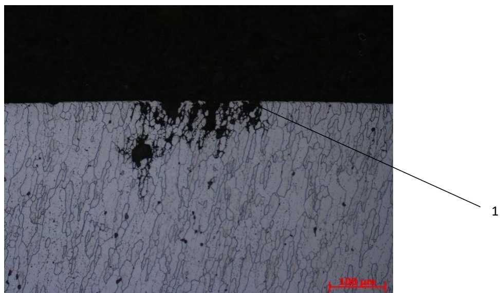
图7 点蚀呈线状的试样图示
