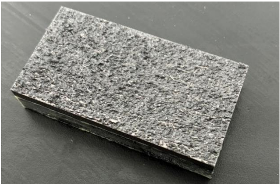
图 11 EB 级典型剥落腐蚀形貌
