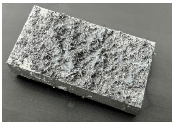
图 13 ED 级典型剥落腐蚀形貌
