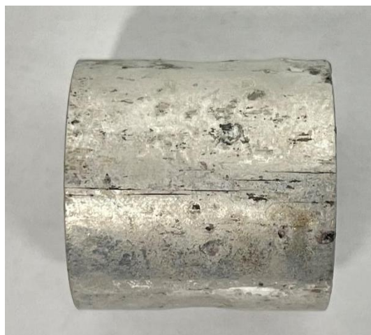
b) 较轻微的应力腐蚀裂纹
