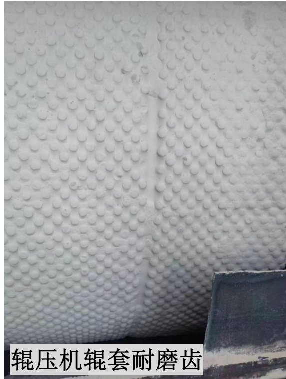
TiC-Fe基硬质合金耐磨齿
