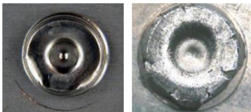
a) 铆钉钉脚出现裂纹
