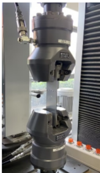
图 24 抗剪拉伸试验示意图
