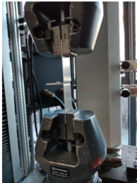
图22 剥离拉伸试验示意图
