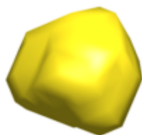
图 D.4 尺寸规格为 420mm×1420mm 的 7050 铝合金均匀化态扁铸锭边部典型显微疏松形貌
