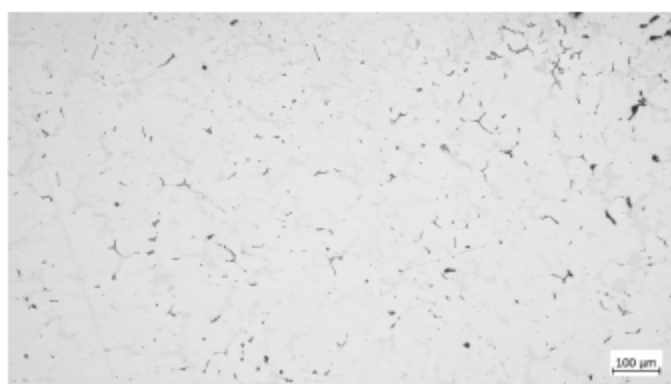
图 A.13 3XXX 系铝合金 II 级显微疏松形貌示例
