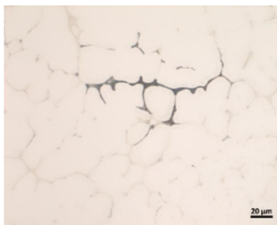
图 A. 25 7XXX 系铝合金 II 级显微疏松形貌示例
