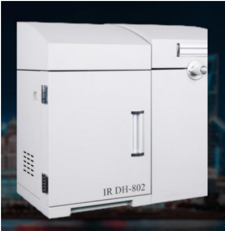
图 2 型号为 IRDH-802 的测氢仪
