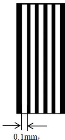
图C.1 型号/规格：5.0LP/mm，线条宽度为0.1mm的射线图像分辨力测试计
