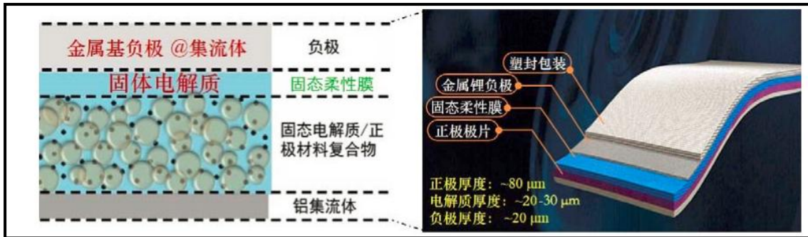
图 2 利用固态柔性电解质膜构建的固态锂电池
