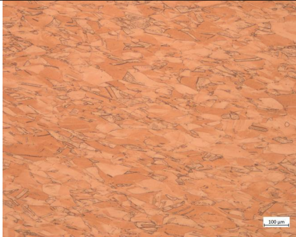
合金牌号 T2 倍率：200× 工艺条件 直径Φ50mm 紫铜棒材冷拉至Φ25mm 浸蚀剂 硝酸高铁酒精溶液 抛光方式 机械抛光 组织说明 α 单相组织，晶粒变形拉长。
