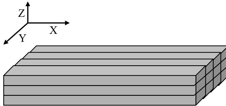
图 1 性能试样取向定义示意图
