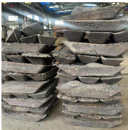
图 A.2 铜捕集 PGM 合金
