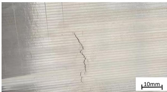
图 B.1 热裂纹低倍组织
