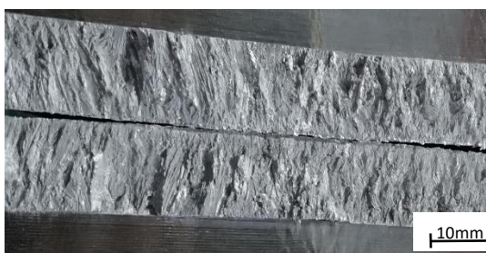
图 B. 4 柱状晶断口组织
