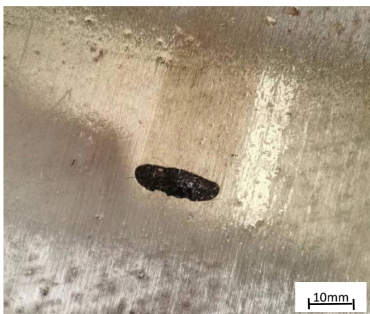
图 B.2 熔剂夹渣低倍组织
