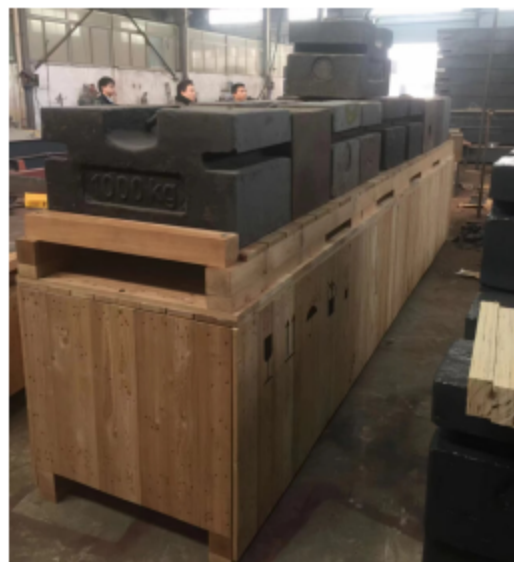
图9 包装箱抗压试验（静载试验）
