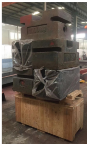
图10 包装箱堆码试验
