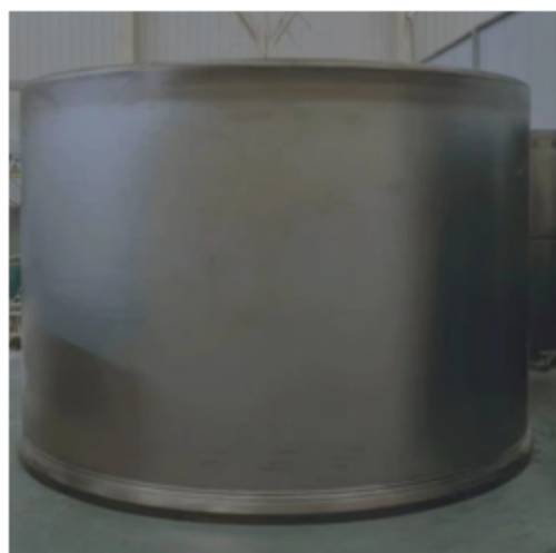
图 4 无缝旋压成型阴极辊用钛筒
