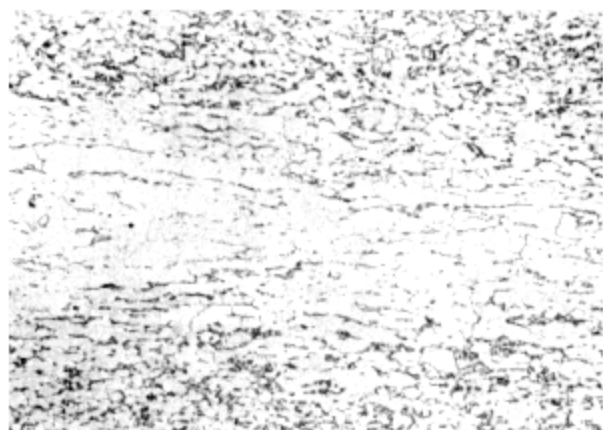
图 30 高间隙缺陷 TC4 (TC4 正常区 Hv=300; 偏析区 Hv=493) 200×
