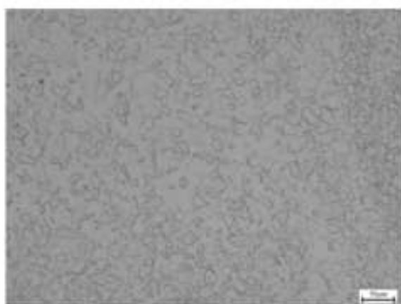
图 10 浸蚀剂 g 和 j 浸蚀后高倍组织
