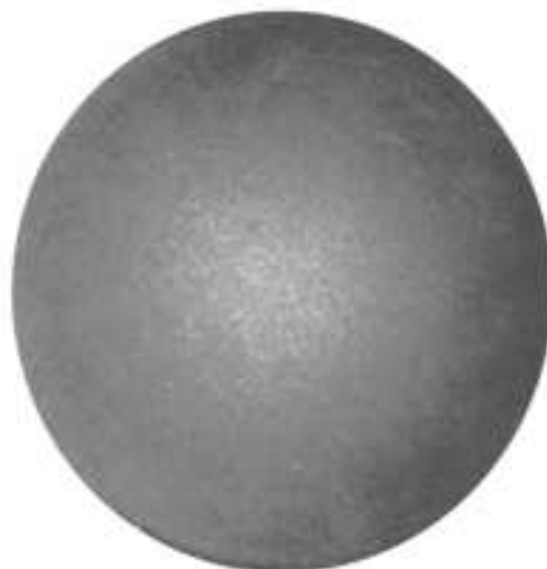
图5 浸蚀剂 e 降温处理浸蚀低倍组织
