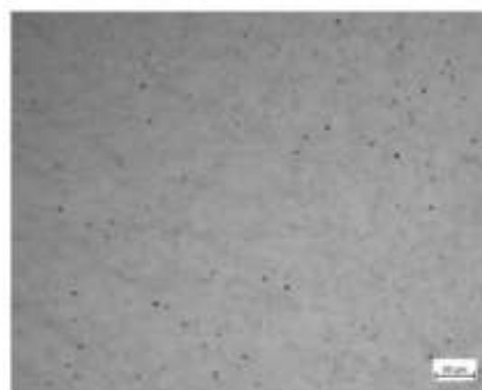
图 7 抛光液 b 化学抛光组织
