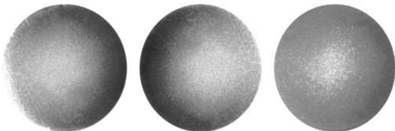
图1 浸蚀剂 a 浸蚀后低倍组织 图2 浸蚀剂 b 浸蚀后低倍组织 图3 浸蚀剂 c 浸蚀后低倍组织
