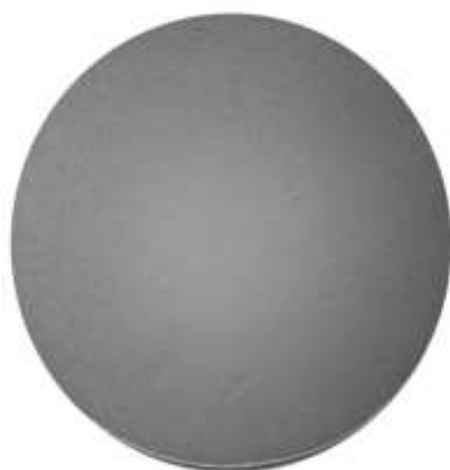
图4 浸蚀剂 d 降温处理浸蚀低倍组织
