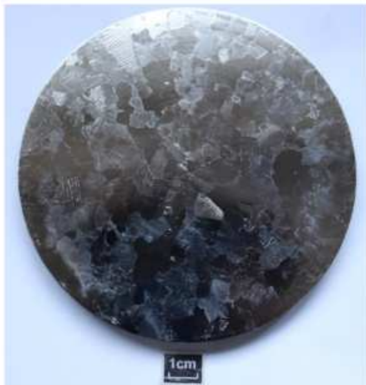
图 A.3 H01 棒材低倍组织（铸锭）
