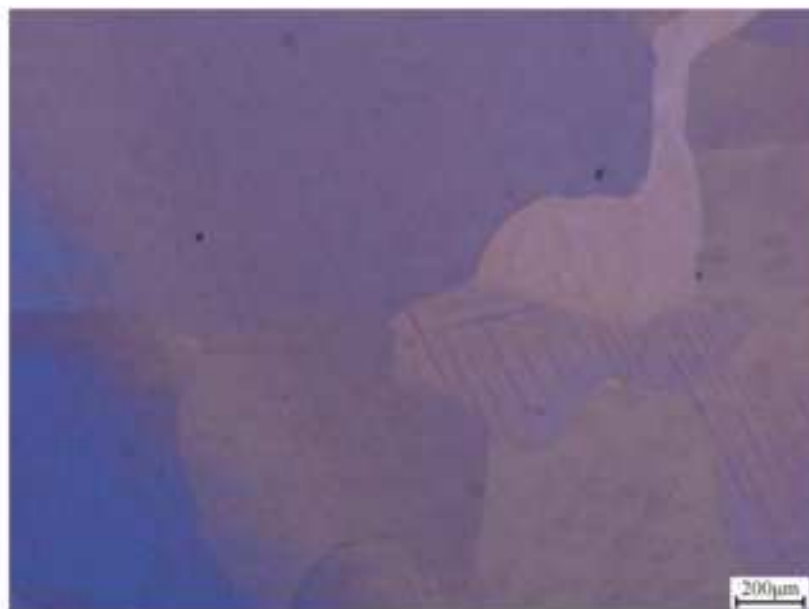
图 B.11 高倍组织（铸锭 Z 态）
