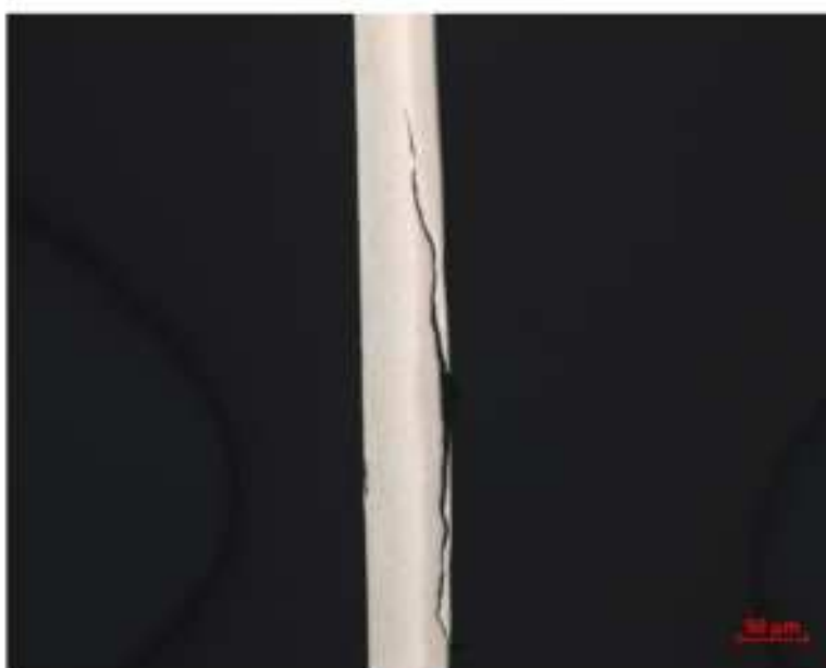
图 B.16 箔材（边部存在裂纹）
