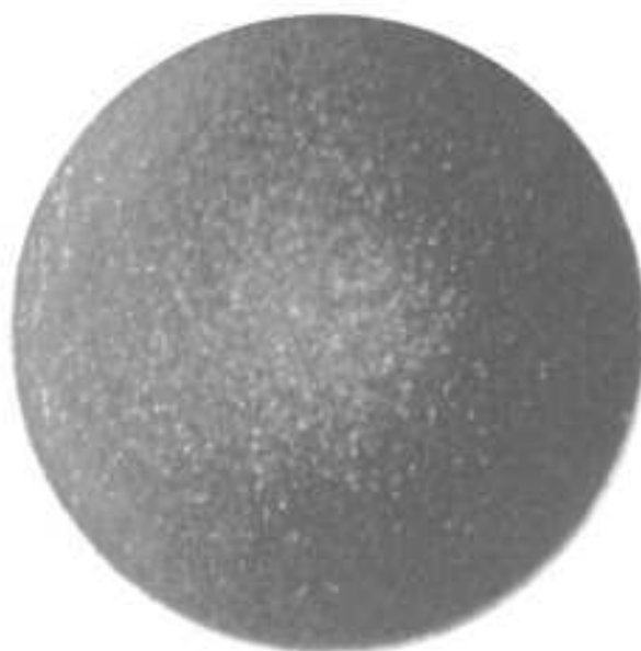
图 A.2 H01 棒材低倍组织 (心部腐蚀坑较多)
