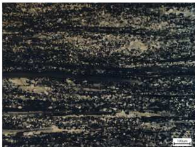
图 B. 6 H01 高倍组织（部分未完全再结晶）
