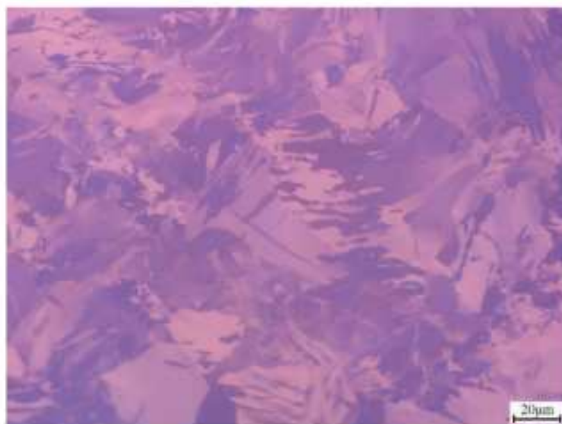
图 B.4 H01 高倍组织（未完全再结晶）
