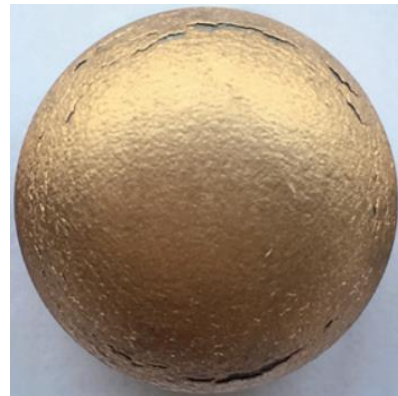
b) 过渡圆弧区域表面脱层爆皮
