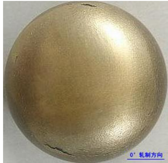
b) 过渡圆弧区域表面局部爆裂纹
