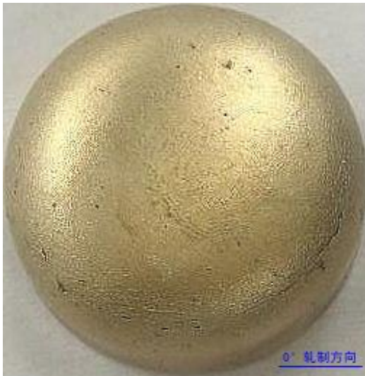
a) 过渡圆弧区域表面裂纹
