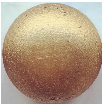
a) 过渡圆弧区域表面裂纹
