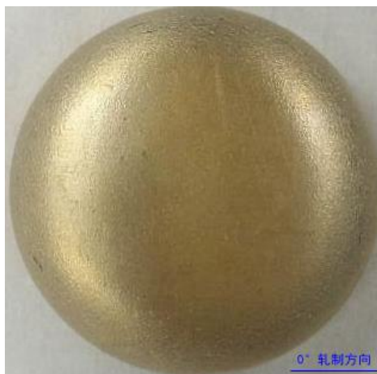
b) 过渡圆弧区域表面微裂纹
