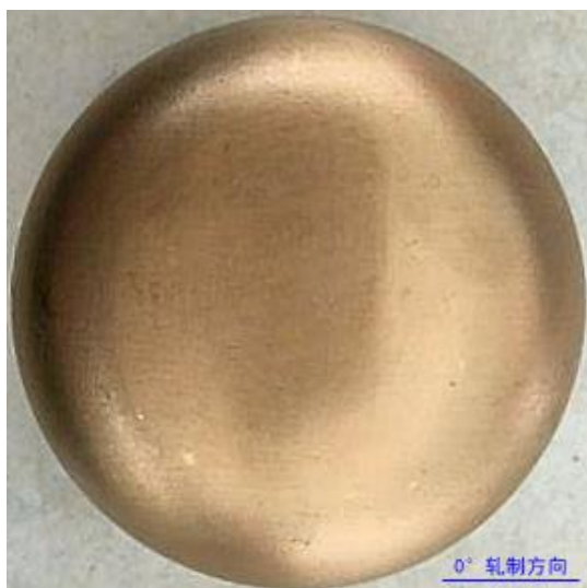
a) 过渡圆弧区域表面局部微裂纹
