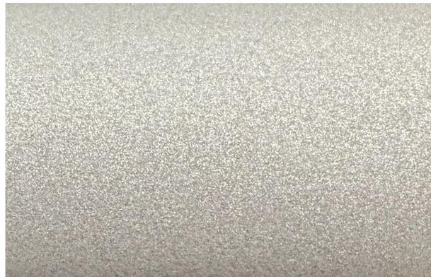
图 A.2 管材外表面二级晶粒度典型照片
