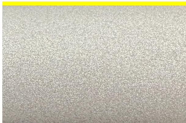
图 A.3 管材外表面一级晶粒度典型照片
