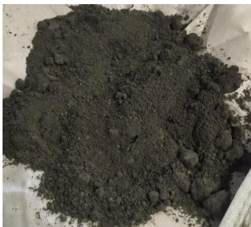
图 2 以红土镍矿为原料生产的粗硫化镍钴外观图片
