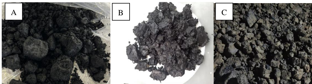
图 4 以含镍钴废液为原料生产的粗硫化镍钴外观图片
