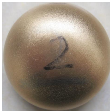
a) 冲杯试验后冲杯体表面底部圆角弧区域无裂纹形貌
