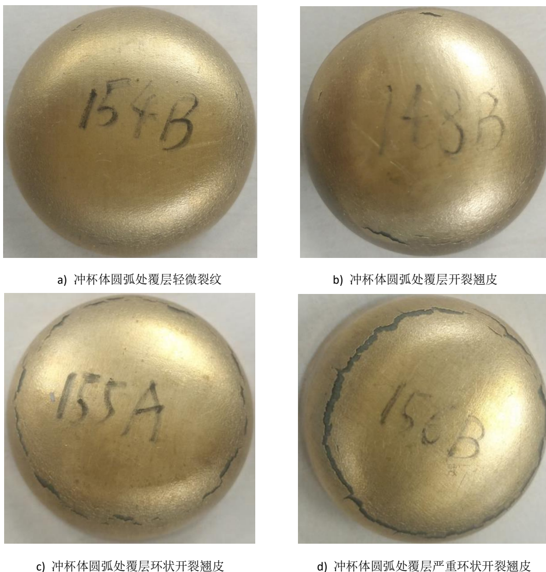
图 1 冲杯试验后冲杯体外底部裂纹缺陷形貌图
