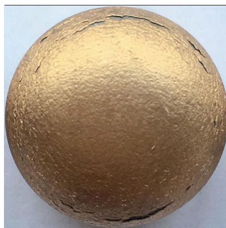
b) 冲杯试验后冲杯体表面底部圆角弧区域裂纹形貌
