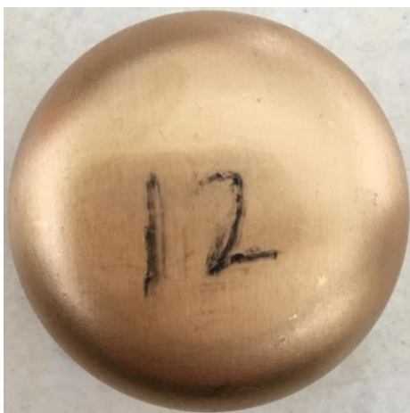
a) 冲杯试验后冲杯体表面底部圆角弧区域无裂纹形貌
