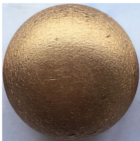
b) 冲杯试验后冲杯体表面底部圆角弧区域裂纹形貌
