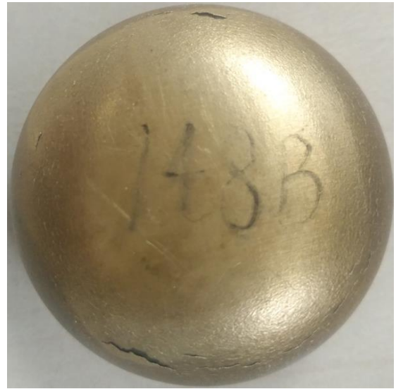
b) 过渡圆弧区域表面局部爆裂纹
