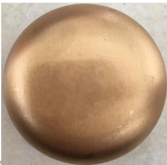
a) 过渡圆弧区域表面局部微裂纹
