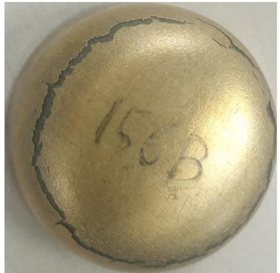
b) B面冲杯后圆角过渡圆弧区域环状爆裂纹
