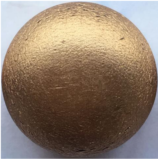
a) 过渡圆弧区域表面裂纹
