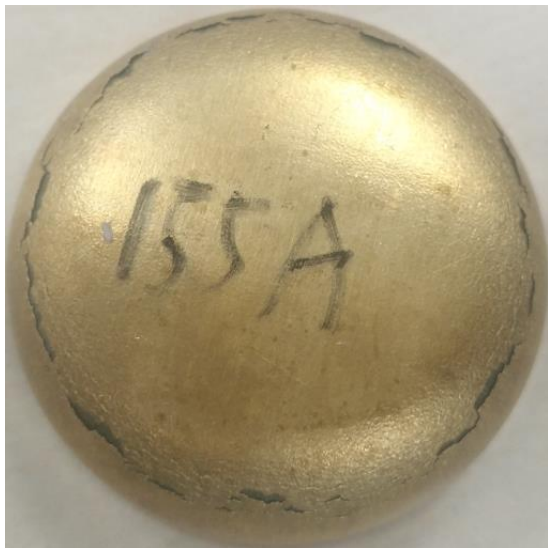
a) A面冲杯后圆角过渡圆弧区域环状裂纹
