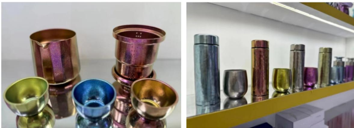
图 7 不同的颜色的钛及钛合金阳极氧化膜
