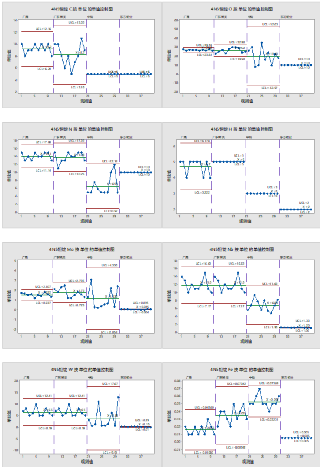
图 2 GTD4N5 钽锭不同企业的主要化学成分实际控制水平对比
