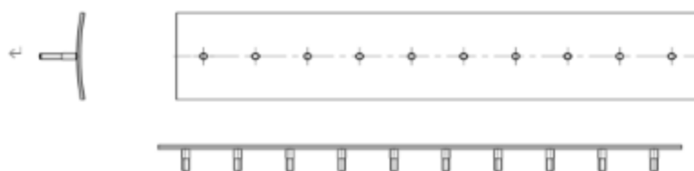
图2 背拉式钛阳极的示意图。
