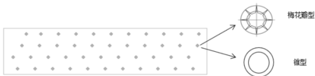
图1 沉孔式钛阳极的示意图。
