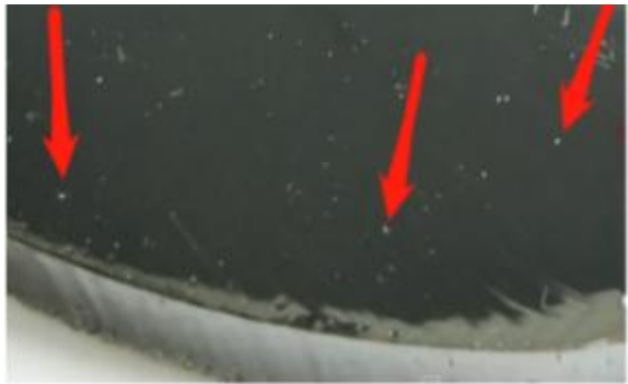
图 6 晶锭微管缺陷（强光手电光照，肉眼观察）
