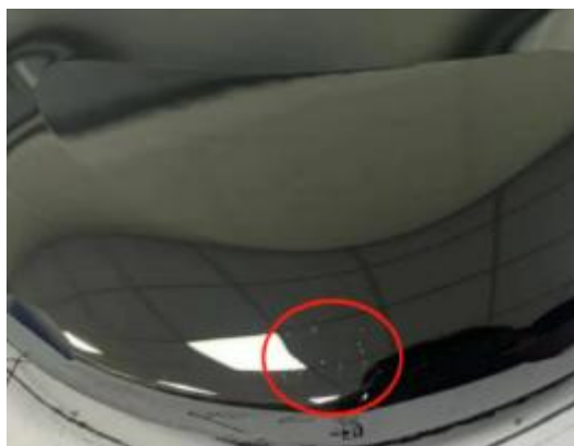
图7 晶锭微管密集区(强光手电光照, 肉眼观察)
