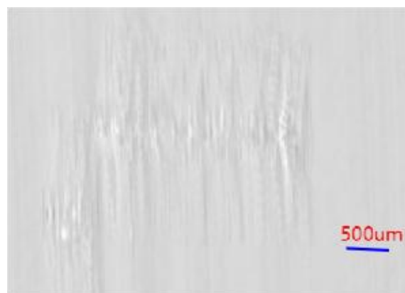
图 91 划痕引起的台阶聚集 Qzr0 图像（Candela 8520，激光散射法）
