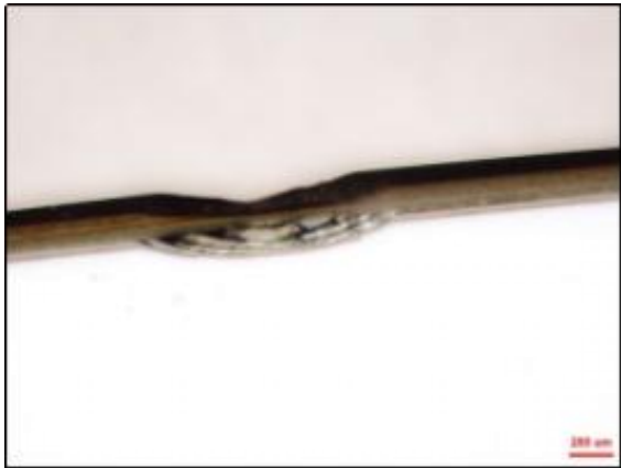
图 39 缺口（光学显微图像）
