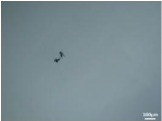
图 15 碳包裹体 2（光学显微图像）
