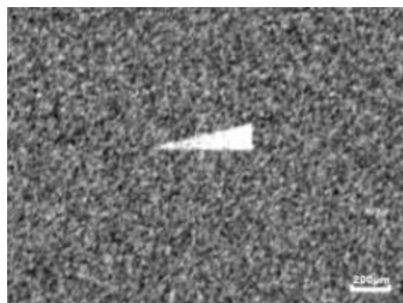
图 19 Shockley 型层错 (PL 图像)
