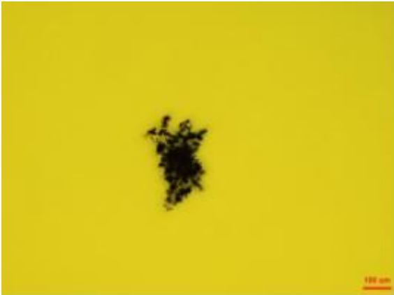
图 14 碳包裹体 1（光学显微图像）
