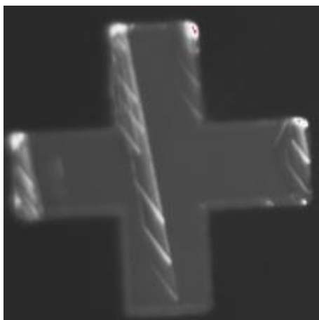
图 137 源于台面侧壁的缺陷传播 (p+nn+二极管, 30 min)
