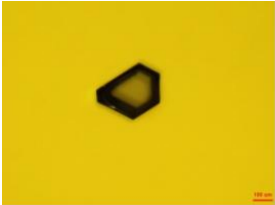
图 17 六方空洞 1（光学显微图像）
