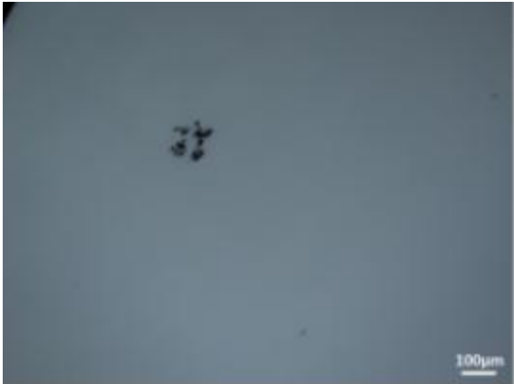
图 16 碳包裹体 3（光学显微图像）
