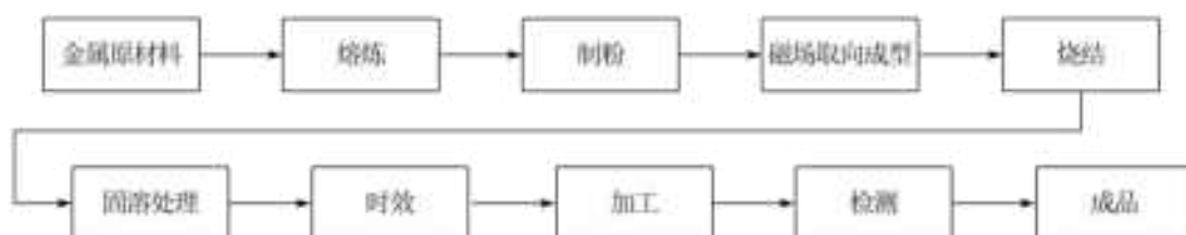
图B.1 2：17型烧结钕钴永磁材料工艺流程
