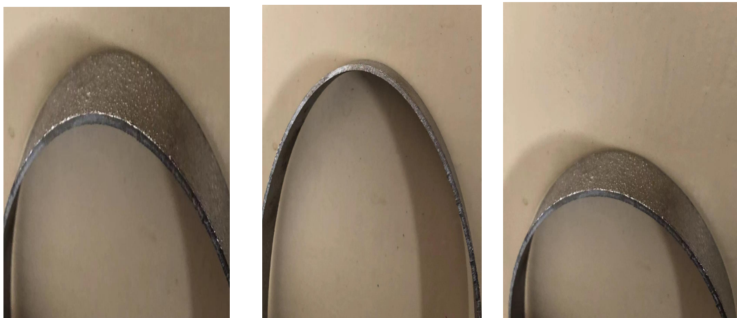
图2 钛基钛锰合金复合层弯曲性能
