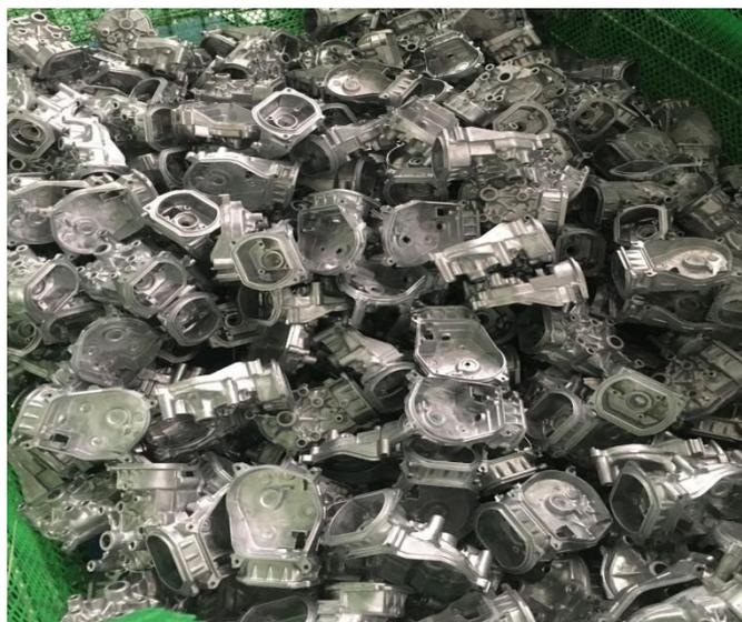
图 A.4 同牌号料——来源于单合金新铝铸件（见 GB/T 13586-2021 表 1 中 Tread B）
