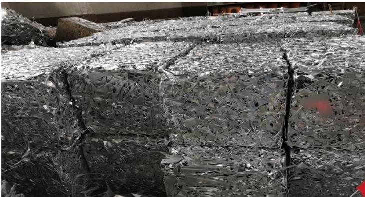
图1 铝块易拆包-来源于混合新加工余料及几何废料（见GB/T 13586-2021表1中Tough A）
