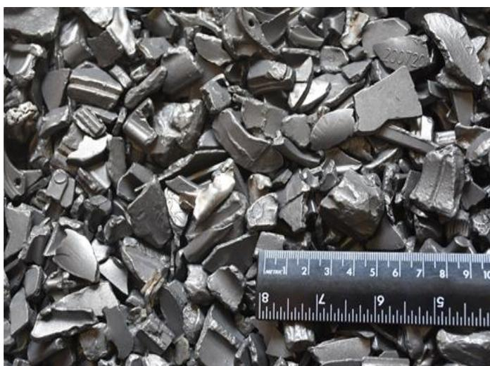
图 A.8 小块——来源于混合金属破碎料（见 GB/T 13586-2021 表 1 中 Zorba）
