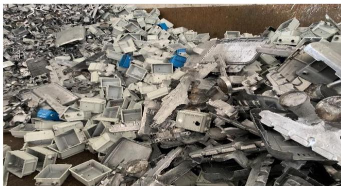
图 A.5 多系列料——来源于混合铝铸件（见 GB/T 13586-2021 表 1 中 Tense）
