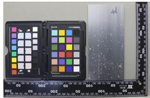
图A.40阳极氧化复合膜B级, CASS96H, H2
