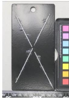
图A.57 喷粉，鼓泡、丝状10mm， AASS1000h
