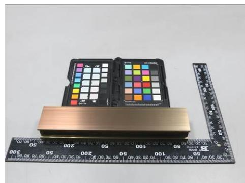
图A. 28阳极氧化复合膜B级, CASS72H, 2-B3
