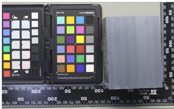
图A. 8 AA10阳极氧化+中温封孔CASS 16h B2
