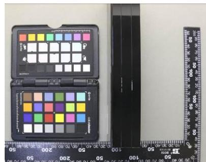
图A.44阳极氧化复合膜B级, 耐碱24H, 19-H6
