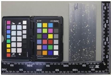
图A.43阳极氧化复合膜B级, CASS120H, 18-H6
