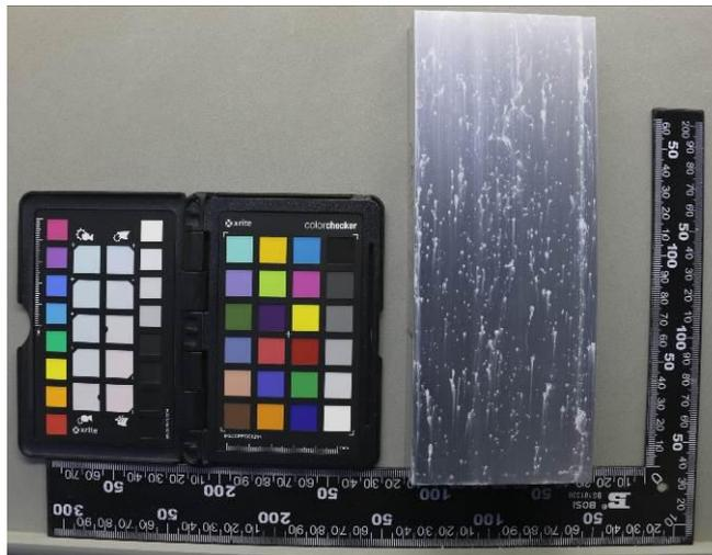
图A. 26 (AA15阳极氧化+常温封孔CASS 72h) H2
