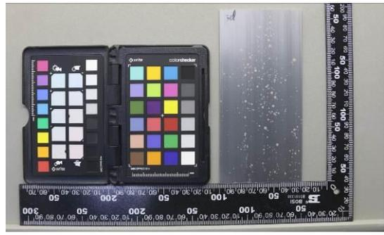
图A.38阳极氧化复合膜B级, CASS72H, H1
