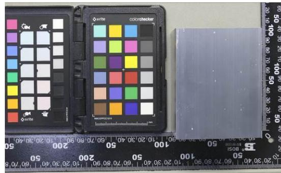
图A.14 (AA10阳极氧化+中温封孔CASS 16h) C4
