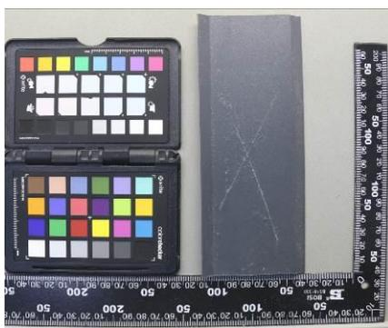
图A.60 喷金属粉鼓泡、点腐蚀B4级, CASS72h
