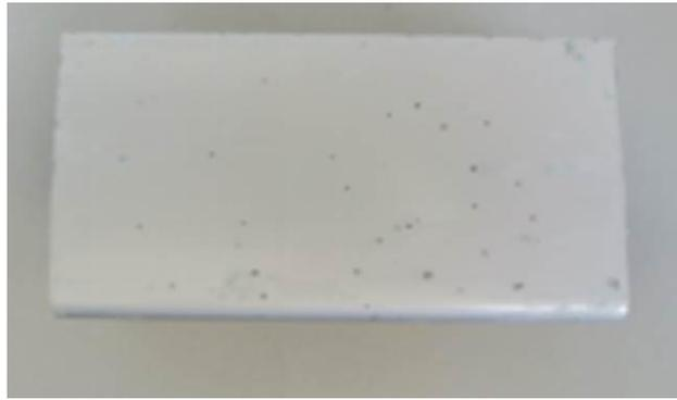
图A. 45 阳极氧化复合膜B级120H, 20-F2 (无标尺)
