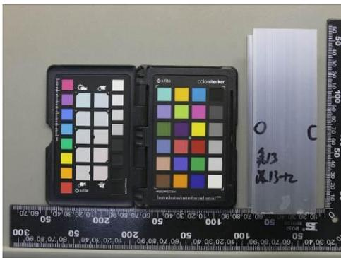
图A. 27 阳极氧化复合膜B级, CASS72H, B2
