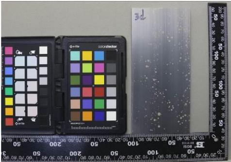
图A.41阳极氧化复合膜B级, CASS72H, 16-H3
