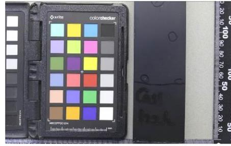
图A. 30阳极氧化复合膜B级, CASS122H, B4
