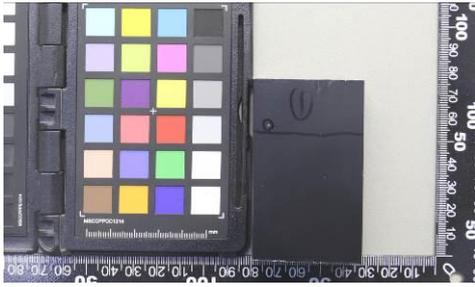
图A. 29阳极氧化复合膜B级, CASS148H, B3
