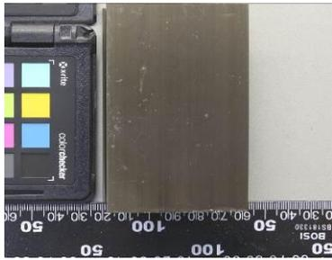
图A. 31 阳极氧化复合膜B级, CASS72H, C4
