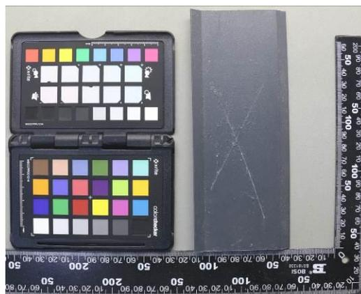
图A. 喷金属粉鼓泡, 点腐蚀B4级, CASS72h
