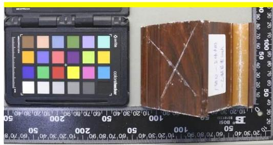
图A. 46 喷粉木纹, 点腐蚀D1级, AASS1000h (角度不符合)
