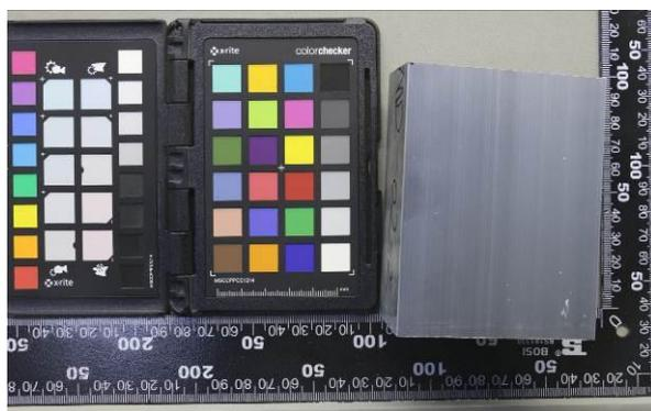
图A. 9 AA10阳极氧化+中温封孔CASS 16h B3
