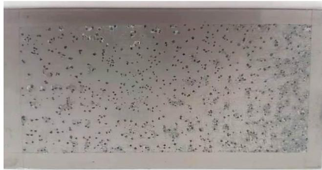
图2 点腐蚀典型宏观图示
