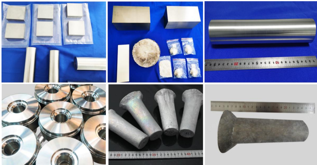
图 2 市场上生产的 FeCoNiCr 系高熵合金板材、棒材及纽扣锭
