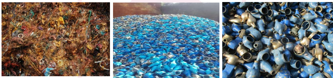
图 7 典型有涂层的物料-漆包线、黄铜水表壳
