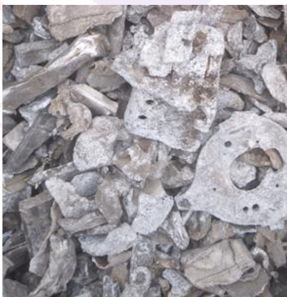
图 9 表面腐蚀严重的铝块
