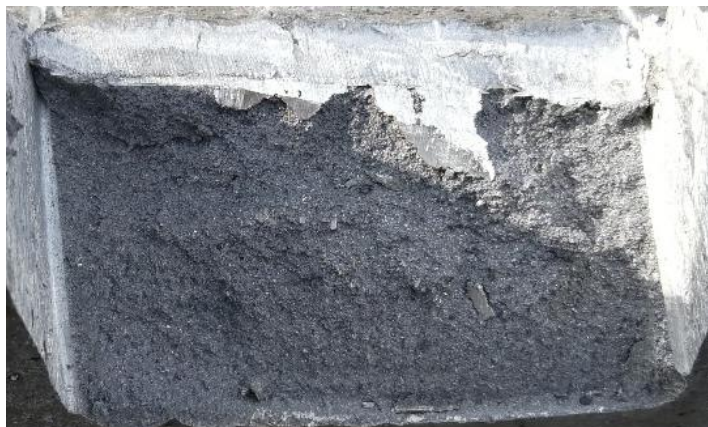
图 8 假冒的再生铝锭（内部非致密的铸造组织的回收铝）
