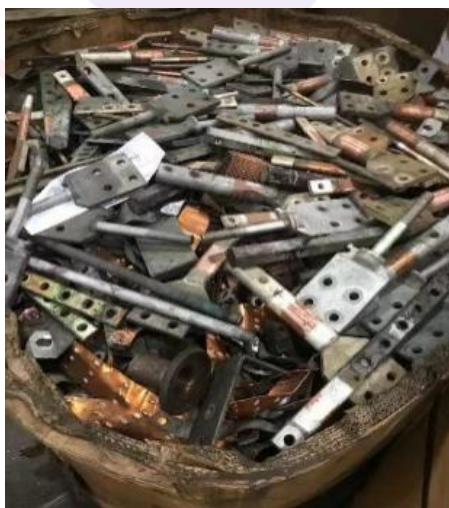
图3 2号铜材中含有表面镀层的原料
