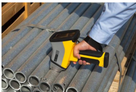
图 2 现场借助便携式 XRF 或便携式光谱仪测量
