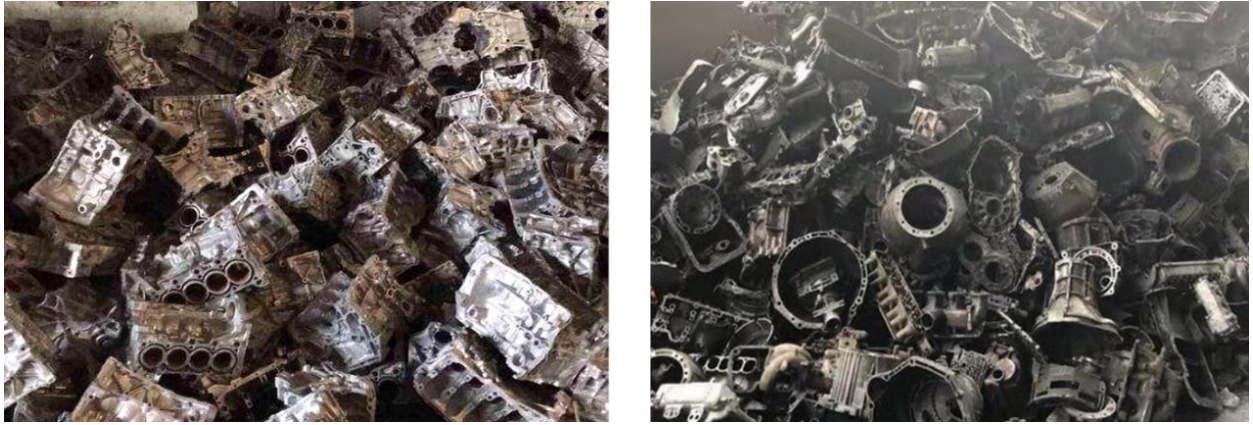
图5-4 夹杂严重的铝废铸件
