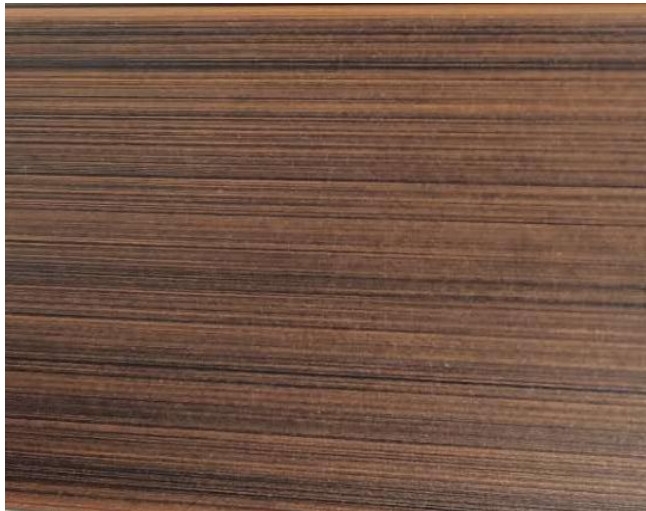
图 A. 29 粉末喷涂+油墨涂覆+液体漆涂装
