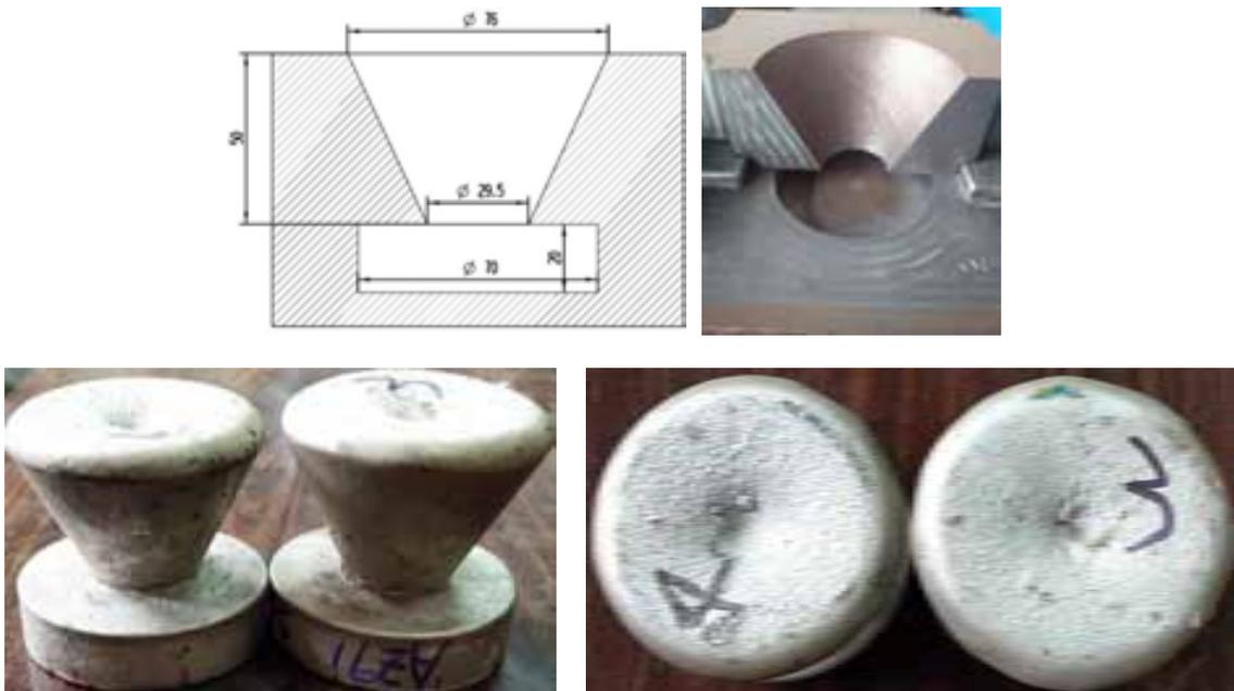
图 2 铸造用断口试样的模具形状和尺寸、以及断口试样
