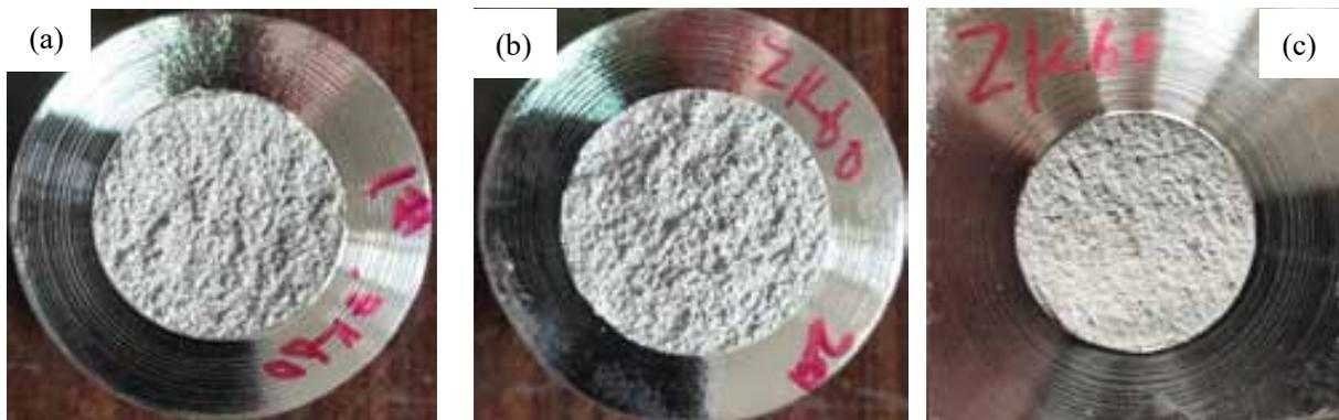
图 11 ZK60 合金亮度检测用断口
