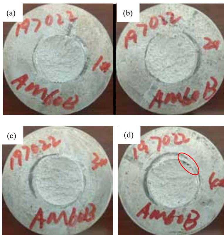
图 23 AM60B 合金亮度检测用断口
