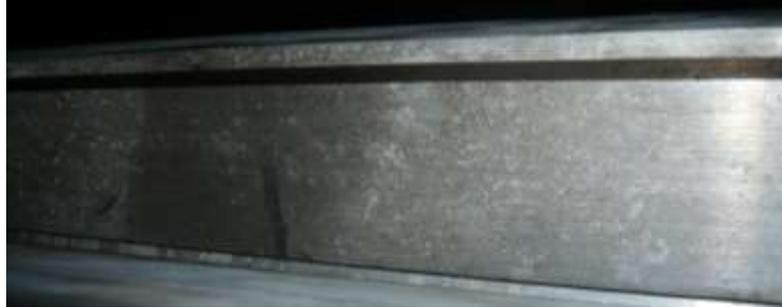
图 14 表面腐蚀
