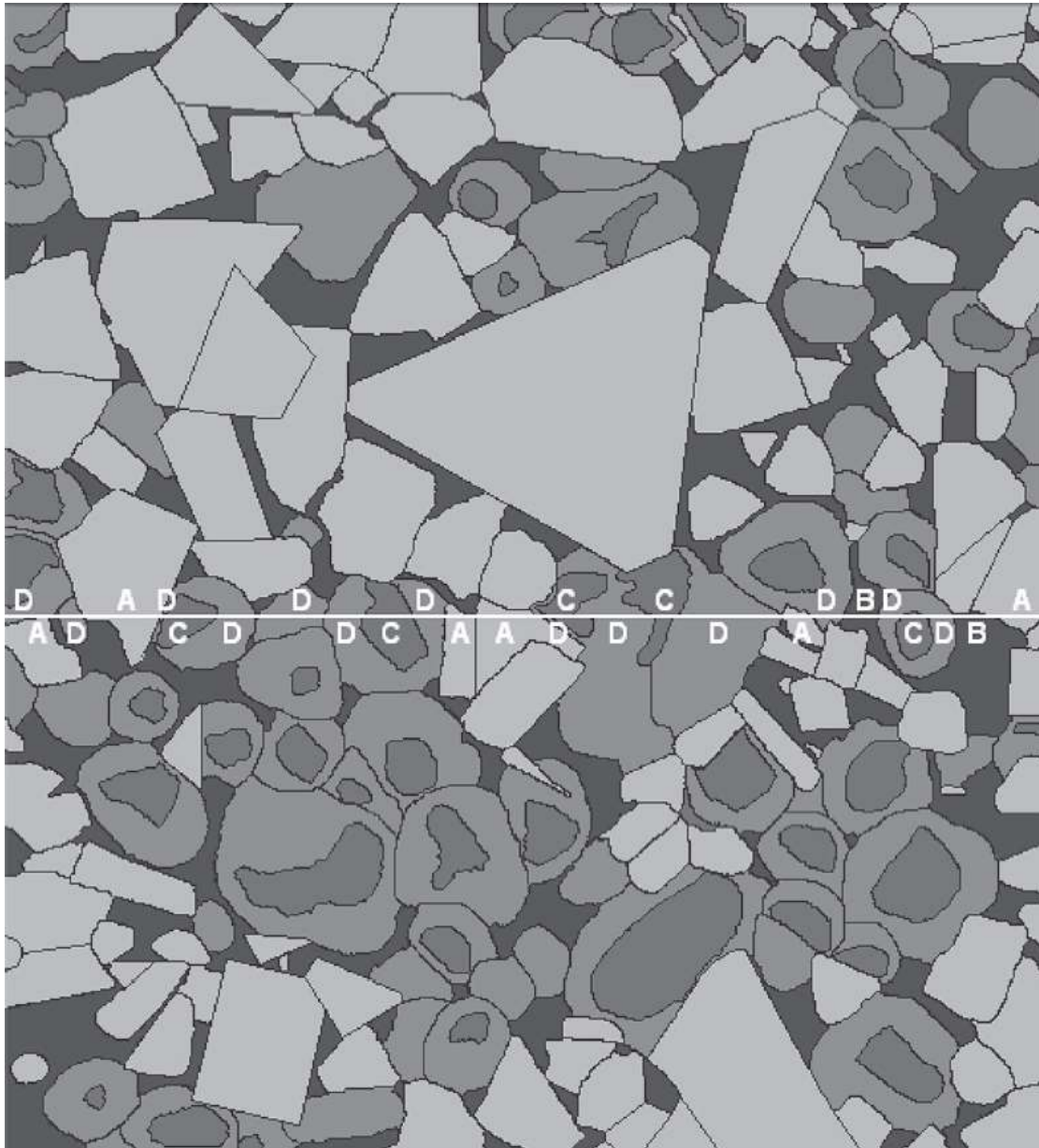
图 21 典型立方碳化物硬质合金显微结构示意图，其中截线穿过显微结构中的每一部分（WC，Co，立方相核心，立方相外层）
