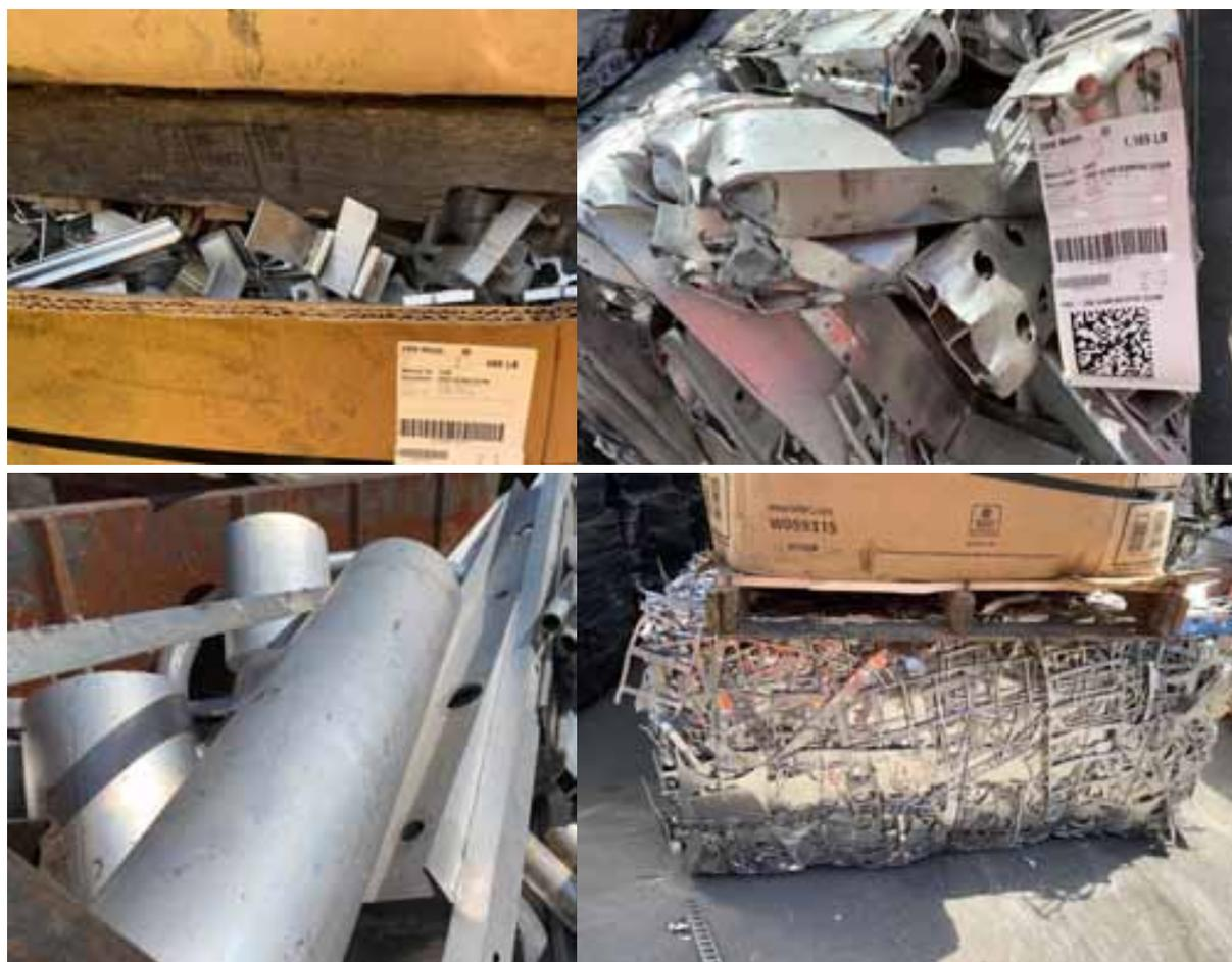
图 5-10 无涂层、无复合材料的废铝合金片
