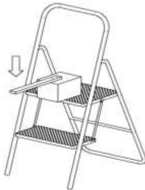
图C. 21 意外折叠性能试验示意图
