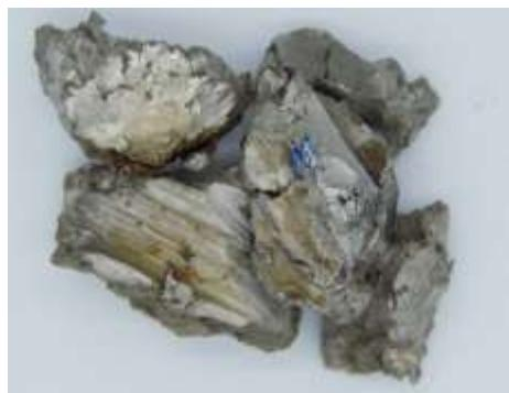
图2 破碎工序氧化的海绵钛块
