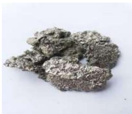
图5 含铁高的海绵钛块
