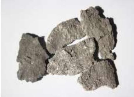
图4 带残渣的海绵钛块
