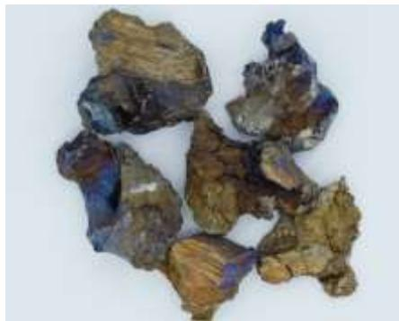
图1 还蒸工序氧化的海绵钛块
