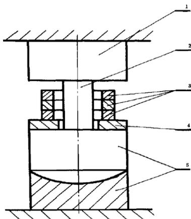
图 1 可调球座垫板装置示意图
