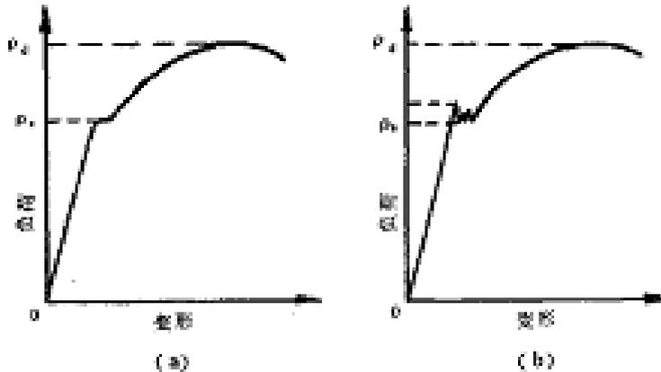
图 2 压缩试验负荷-变形曲线
