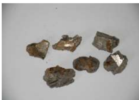
图 9 表面被污染的海绵钛块
